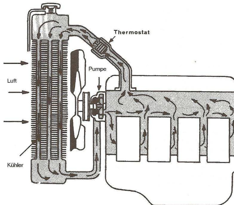
Bei der Wasserkühlung sind die zu kühlenden Teile von einem Wassermantel umschlossen. Das Wasser nimmt die Wärme auf und gibt sie im Kühler an die Luft ab. Das abgekühlte Wasser fließt zum Motor zurück. Ein Lüfter verbessert die Kühlung, vor allem bei stehendem Fahrzeug und bei langsamer Fahrt. Durch den Einbau einer Wasserpumpe wird die Umlaufgeschwindigkeit des Kühlwassers wesentlich erhöht.
